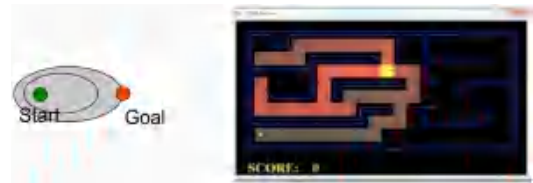
图 32 A* 算法主要朝着目标点方向探索
